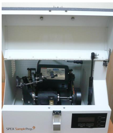
2 Сурет – Жоғары энергетикалық ұнтақтау диірмені SPEX SamplePre 8000M
